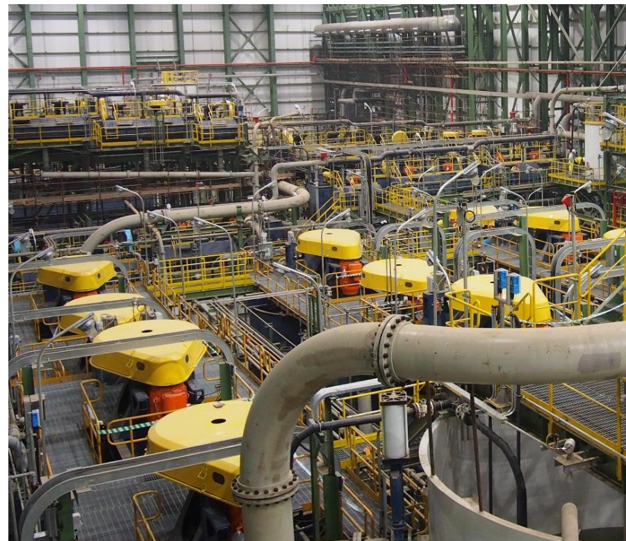
Бозшакольская фабрика по переработке каолинизированной руды, участок флотации
